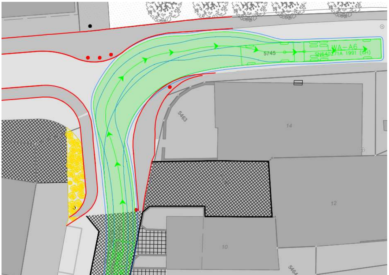
Abbildung 2: Schleppkurve Sattelschlepper Raffor - RyfstrasseWest
