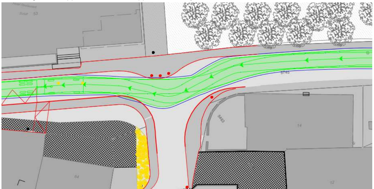
Abbildung 3: Schleppkurve Sattelschlepper RyfstrasseWest – RyfstrasseOst
